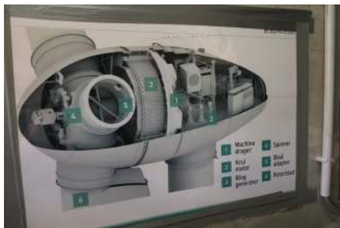
Schema van de opbouw in de gondel van de Coöperwiek
