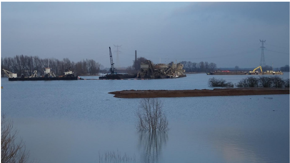
Afferdense en Deestse Waarden: links een zandzuiger, midden een klasseerinstallatie en rechts een stortponton
