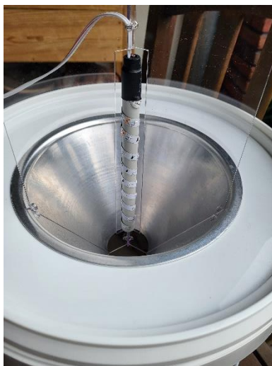
De led-emmer met trechter en led-staaf die gebruikt worden om nachtvinders te vangen (foto's: Marleen Koning)
