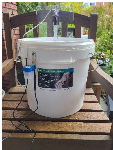
De led-emmer met trechter en led-staaf die gebruikt worden om nachtvinders te vangen (foto's: Marleen Koning)
