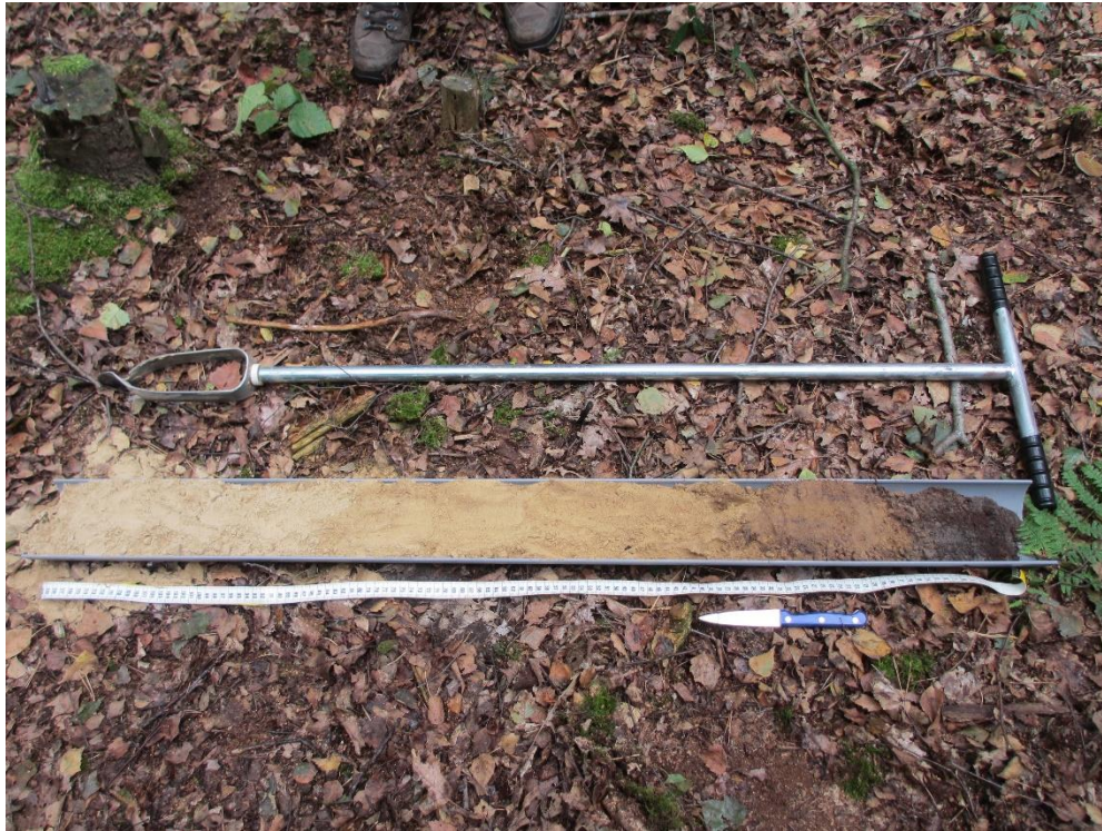
Foto grondboring 1: Steilrand, we hebben hier te maken met een Duinvaaggrond.
