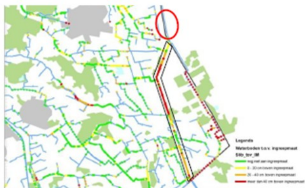
Figuur 2.3: Knelpunten huidige watersysteem. De rode cirkels geven de knelpunten met weinig drooglegging, de stippels over de waterlopen geven de baggeropgave en de zwarte omlijnning geeft de locatie met slechte kades (kanaal van Deurne)
