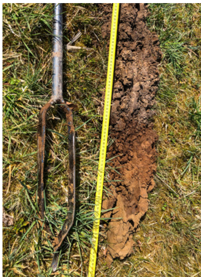
Grondboring op het grote veld. Foto: S. van den Berg.
